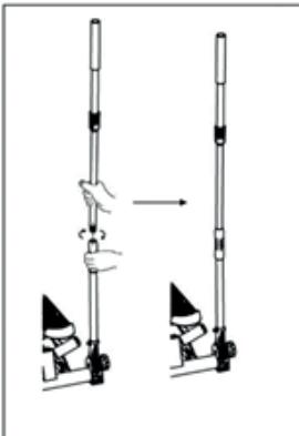
Вставьте верхнюю часть поручня в нижнюю трубку, прокручивая ее по часовой стрелке, после чего зафиксируйте конструкцию. Таким же образом закрепите второй поручень. При необходимости отрегулируйте высоту поручней с помощью соответствующей ручки (№41).
