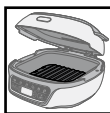
Kontroller, at den sorte reflektor sidder korrekt, og sidder fast på bunden af apparatet
