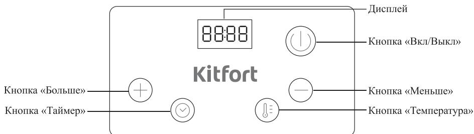
На панели управления расположены дисплей и кнопки регулирования времени и температуры, а также кнопка включения и выключения.
