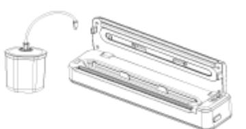
Протрите крышку вакуумного резервуара и сам резервуар, чтобы убедиться, что они чистые и сухие.
