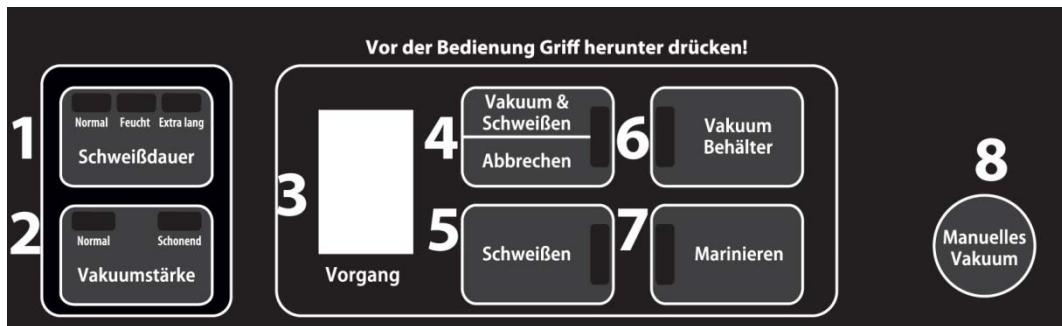
**1 Длительность запаивания / Запаивание:** Три различные установки для выбора длительности запаивания.
