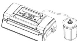
Закрепите один конец вакуумной трубы на патрубке прибора, а другой - на патрубке крышке сосуда.
