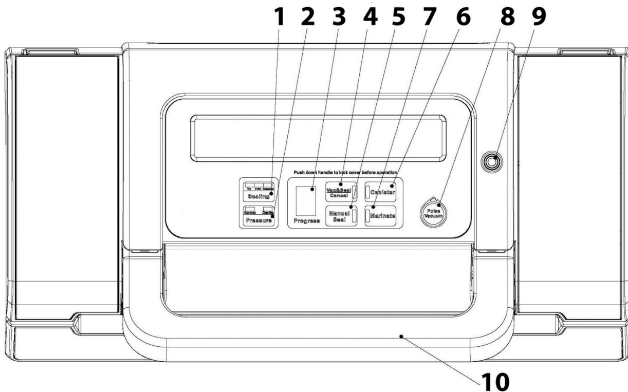
**9 Вакуумная трубка-Подключение:** Для подключения вакуумной трубы для вакуумирования вакуумных сосудов или винных пробок.
