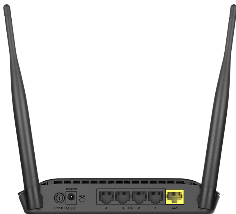
Рисунок 2. Вид задней панели DIR-615S.
