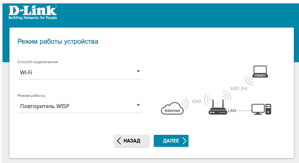
Рисунок 26. Выбор режима работы устройства. Режим Повторитель WISP .
