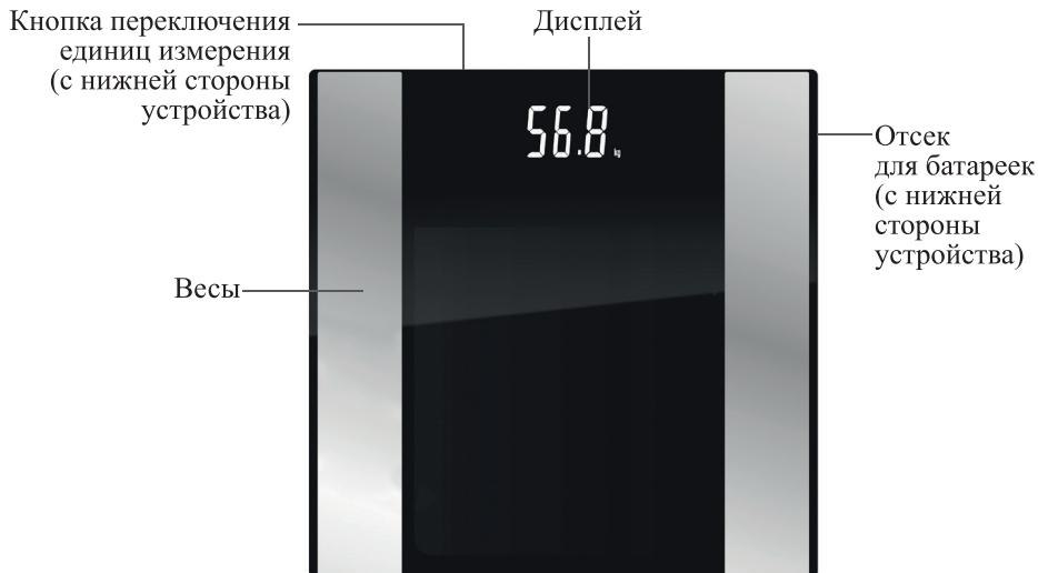
Весы автоматически включаются, когда вы встаете на них. Устройство отключается автоматически через 10 секунд при отсутствии нагрузки.
