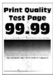
Печать покрыта пятнами и точками
