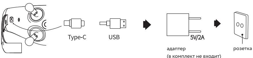
Во время зарядки будет гореть красный индикатор на кнопке «вкл/выкл», после окончания зарядки цвет индикатора поменяется на зеленый. Во время работы прибора при низком заряде аккумулятора индикатор начинает мигать красным, зарядите аккумулятор для продолжения работы.
