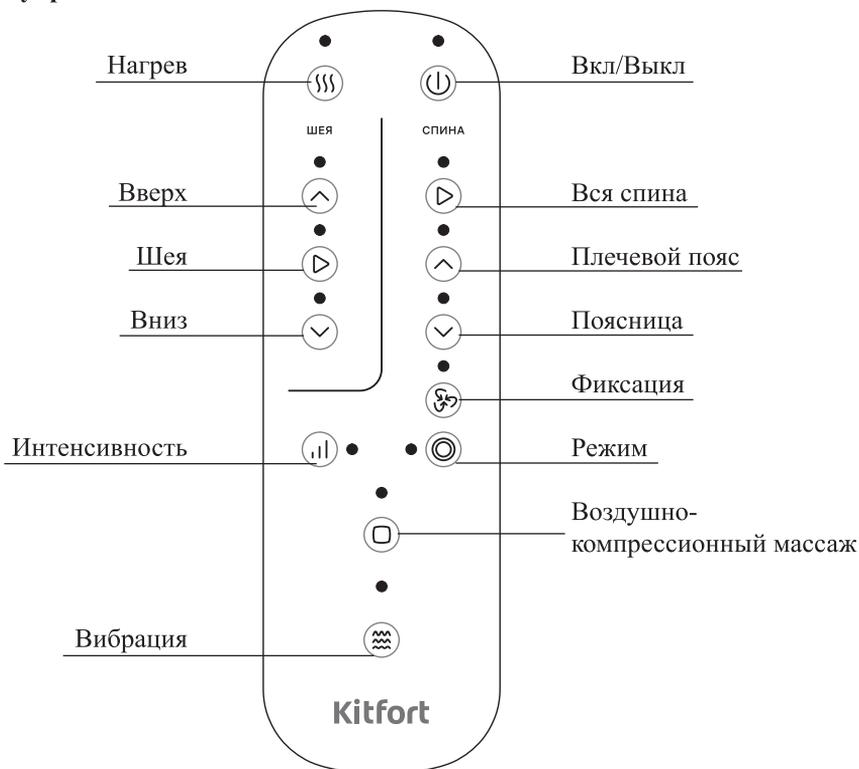
Управление массажером осуществляется кнопками на пульте управления. Рядом с каждой кнопкой расположен индикатор, который загорается при нажатии на кнопку.
