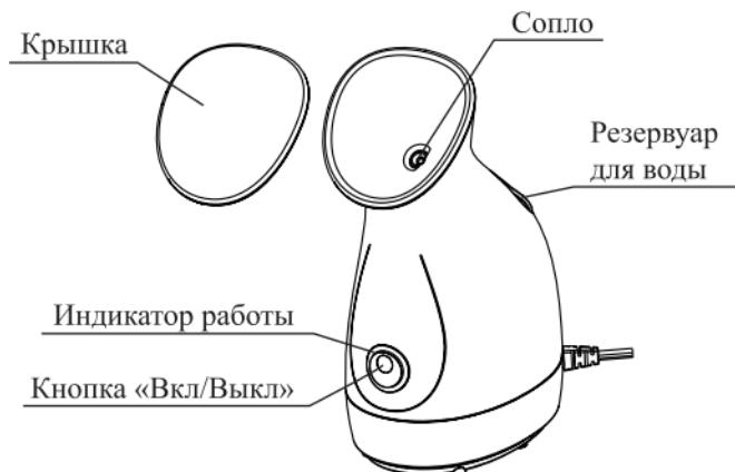
Принцип работы сауны для лица прост. Вода из резервуара под действием силы тяжести поступает в бойлер, где нагревается и испаряется. Пар выходит из сопла устройства.
