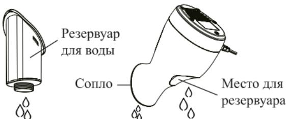
Для уменьшения образования накипи используйте деминерализованную или дистиллированную воду. При образовании накипи и/или при отложении солей в бойлере происходит следующее (в порядке ухудшения ситуации):
