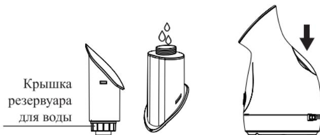
Чтобы продлить срок службы устройства, используйте дистиллированную или деминерализованную воду комнатной температуры.
