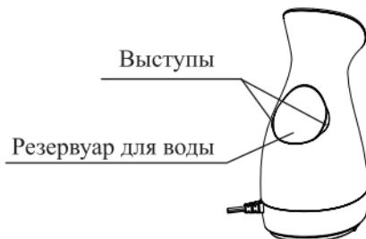
Переверните его, открутите крышку и залейте воду. Затем закрутите крышку, установите резервуар обратно в корпус сауны для лица до упора.
