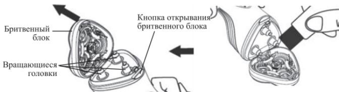
Вы также можете снять и дополнительно прочистить лезвия и сетки. Чтобы их снять, откройте бритвенный блок. Далее снимите внутренний держатель лезвий, повернув против часовой стрелки его фиксатор. Вытащите лезвия из сеток и сетки, затем прочистите их.
