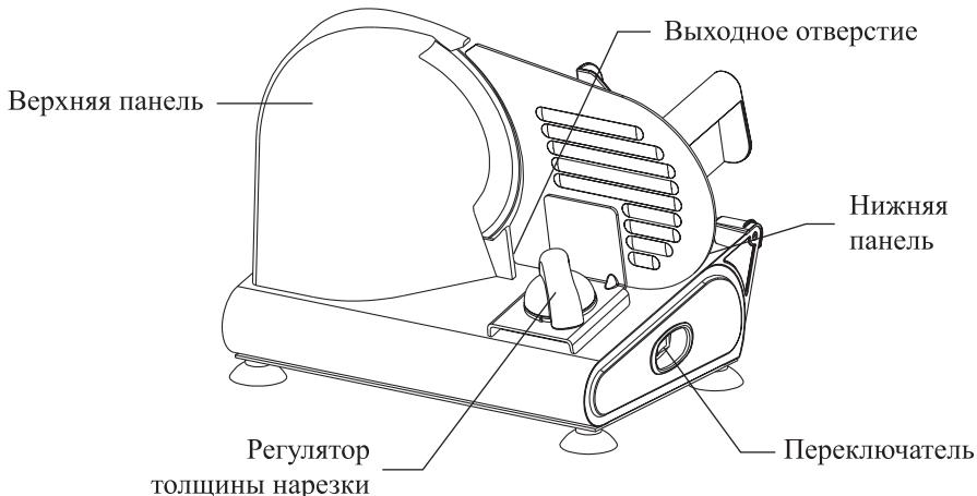
**Корпус** ломтерезки состоит из двух панелей: на **нижней панели** располагается **каретка**, на которую укладывается нарезаемый продукт, на **верхней панели** находится **дисковый нож**. Каретку нужно вручную передвигать по штанге до дискового ножа и возвращать обратно. Штангу с кареткой можно снять с корпуса устройства для легкой очистки, сдвинув **фиксатор штанги**.
