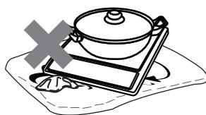
⚠ Металлические предметы, такие как ножи, вилки, ложки и крышки не должны помещаться на варочную область, так как они могут сильно нагреться.
