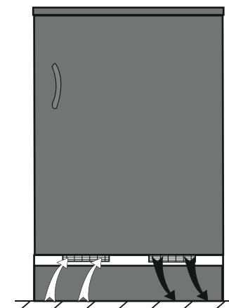
Во избежание снижения производительности каналы всасывания воздуха не должны быть засорены ( $140 \text{ см}^2$ ).
