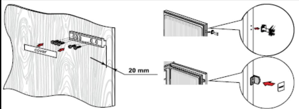
**7.** Установите крышку петли в следующем положении.
