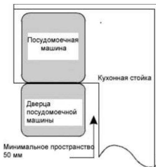
РИСУНОК 2 Минимальное пространство, необходимое для открытия двери.
