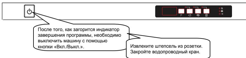
**Примечание:** После звукового сигнала, указывающего на завершение программы (загорания индикатора завершения программы) можно оставлять дверцу открытой, чтобы ускорить процесс высыхания.
