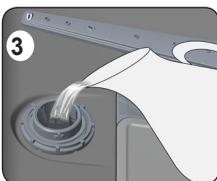
Используйте соль для смягчения воды, специально предназначенную для применения в посудомоечных машинах. Для заполнения емкости солью вначале выньте нижнюю корзину и затем откройте емкость, открутив ее крышку против часовой стрелки. **1 2**
