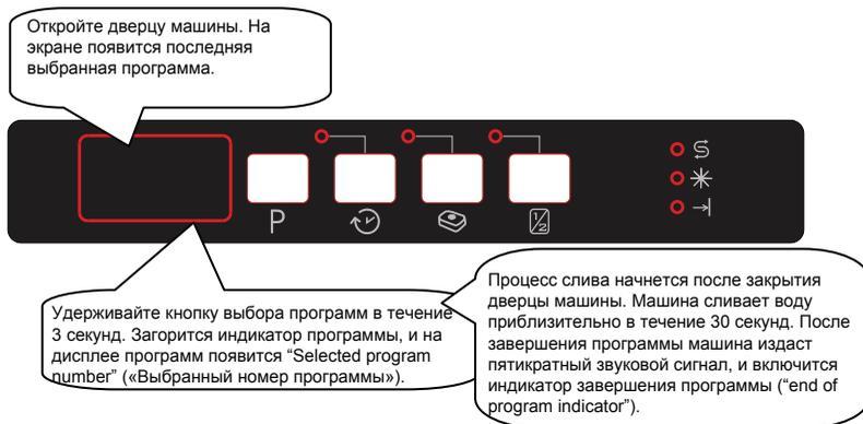
**Примечание:** при открывании дверцы машины для остановки программы мойки до ее завершения следует открывать дверцу на малое расстояние, чтобы избежать разбрызгивания воды.
