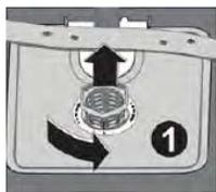
Для снятия блока фильтров для его чистки поверните его по часовой стрелке и выньте, приподняв вверх. **1**
