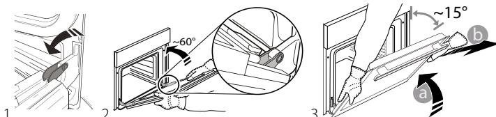
Положите дверцу на мягкую поверхность. Для установки дверцы поднесите ее к духовке, совместите крюки петель с гнездами и вставьте верхние части петель в гнезда. Опустите дверцу, а затем полностью откройте ее. Поверните фиксаторы в исходное положение: вниз до упора. Закройте дверцу и убедитесь, что она находится в одной плоскости с панелью управления. Если нет, повторите приведенные выше шаги.
