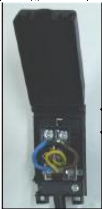
Рис. 2: Электрическое соединение кабеля прибора.
