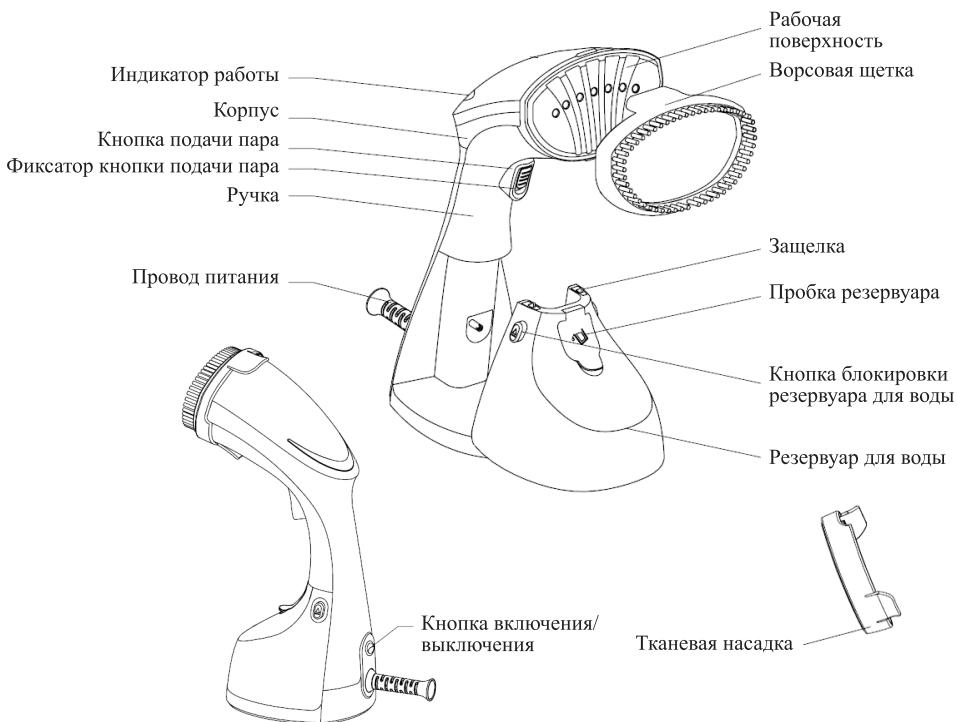
Резервуар для воды у отпаривателя съемный. Вода из резервуара подается в бойлер помпой (водяным насосом), где испаряется, пар выходит через паровые сопла на рабочей поверхности. Использование помпы позволяет точно дозировать количество подаваемой в бойлер воды и получать устойчивую подачу пара. После включения отпаривателя в розетку, индикатор работы начнет мигать, информируя о нагреве. После того, как прибор нагреется, индикатор работы перестанет мигать, информируя о готовности к работе.
