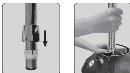
2. Высоту стойки вы можете отрегулировать. Для изменения высоты стойки поверните ее верхнюю часть против часовой стрелки, отрегулируйте высоту и зафиксируйте, повернув верхнюю часть стойки по часовой стрелке до упора (смотри рисунок).
