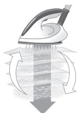
Эта технология обеспечивает непрерывную подачу пара, который глубоко проникает в ткань и упрощает разглаживание складок. При этом прибор имеет меньшие габариты и вес по сравнению с традиционными парогенераторами, что упрощает его хранение.
