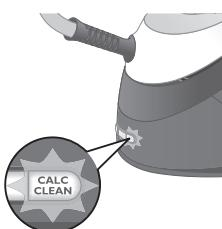
Следите за индикатором Calc-Clean, на приборе раздается звуковой сигнал, напоминающий о необходимости очистки от накипи.
