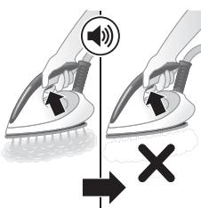
Bununla birlikte, buhar üreticisini kireçten korumak için ikinci bir savunma adımı entegre edilmiştir: eğer kireç çözme yapılmamışsa buhar fonksiyonu devre dışı bırakılır. Kireç çözme işleminden sonra buhar fonksiyonu tekrar etkinleştirilir. Bu durum, kullanılan su türünün önemi olmaksızın gerçekleşir.
