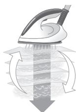
Bu teknoloji kırışıklıkları ortadan kaldırmak için diplere işleyen sürekli buhar üretir. Aynı zamanda, daha kolay depolama için cihazı, geleneksel buhar üreticilerine kıyasla daha kompakt ve hafif tutar.
