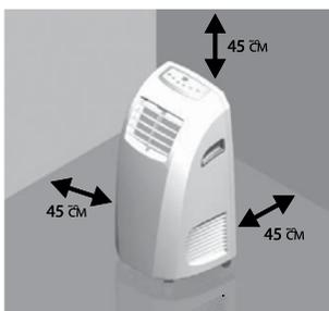
1. Выберите подходящее место для установки кондиционера с удобным доступом к электрической розетке.
