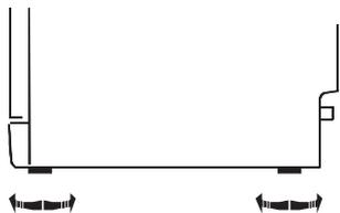
После того как посудомоечная машина установлена, ее высота может быть отрегулирована путем поворачивания ножек. Убедитесь, что наклон посудомоечной машины не должна превышать 2 градуса.
