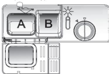
А: отсек для чистящего средства при выборе функции стандартной мойки.
