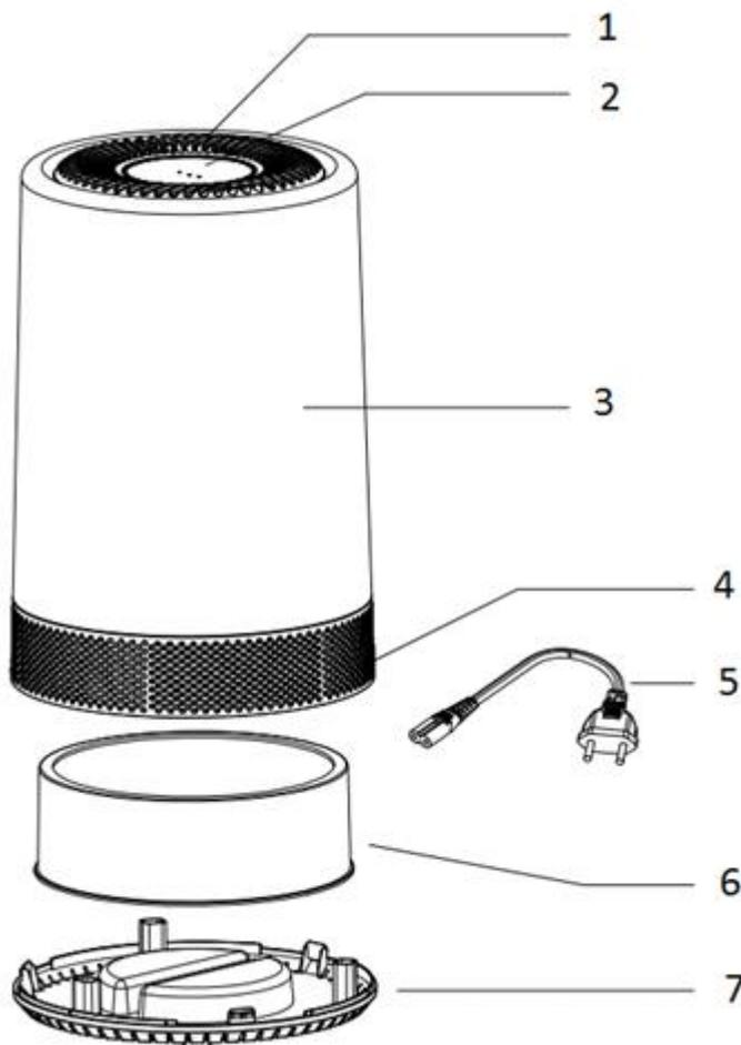
1. Отверстия для выхода очищенного воздуха
