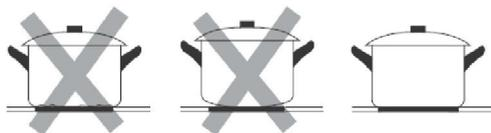
Дно посуды должно быть гладким и ровным, плотно прилегать к варочной поверхности и соответствовать конфорке по размеру. Используйте посуду, диаметр которой равен размеру выбранной конфорки. Если посуда немного больше конфорки, варочная панель работает с максимальной эффективностью. Если посуда меньше конфорки, эффективность работы варочной панели может снижаться. Всегда устанавливайте посуду в центре конфорки.
