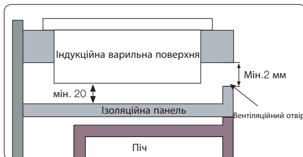
Встановлення варильної поверхні_19
