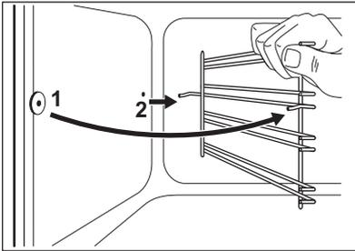
Установка направляющих производится в обратном порядке.
