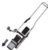
После извлечения контейнера для пыли поверните сетчатый фильтр против часовой стрелки для его снятия.
