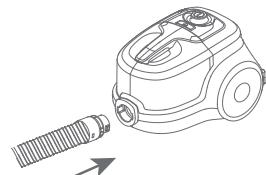
② Чтобы отсоединить шланг, возьмитесь за основную трубку, поворачивайте ее против часовой стрелки до тех пор, пока ее нельзя будет повернуть, а затем вытяните.
