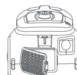
**④** Откройте входной и выходной фильтры и промойте их водой
