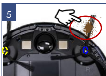
5 Перевірте, чи немає в щітках сміття, зніміть його
