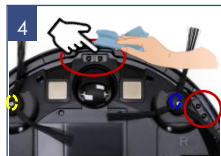
ИҚ датчиктерді абайлап сүртіңіз
