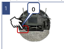
Аспапты I/O ауыстырып-қосқышпен «О» жайғасымға ауыстырып сөндіріңіз
