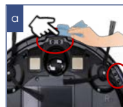
ИҚ датчиктерді абайлап сүртіңіз
