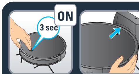
**RU** Чтобы зарядить робот, нажмите и удерживайте кнопку включения в течение 3 секунд. Поместите робот на зарядную станцию так, чтобы его контактные пластины касались клемм на зарядной станции. Возвращайте робот на зарядную станцию каждый раз после завершения использования.
