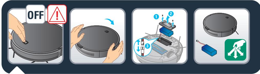
**RU** Внимание! Выключите робот перед извлечением аккумулятора. Для доступа к отсеку аккумулятора, переверните робот, нажмите на защелки отсека и извлеките аккумулятор. Утилизируйте робот и аккумулятор.
