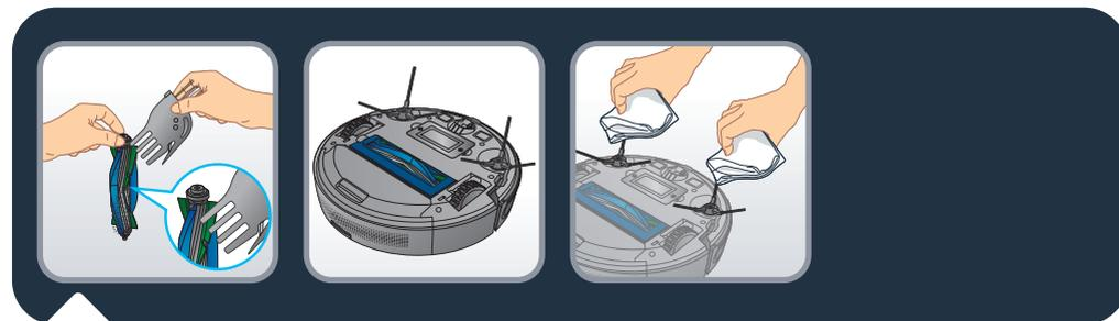
**RU** Для очистки щетки от волос, воспользуйтесь специальным инструментом в комплекте или ножницами. Очищайте боковые щетки робота чистой сухой тканью не реже одного раза в месяц.
