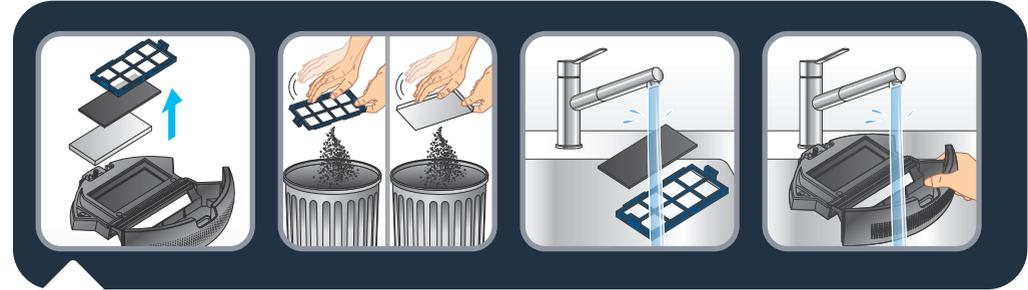
**RU** Очистите крышку фильтра и фильтр, постучав по его задней стороне над мусорным ведром. Промойте чистой водой поролоновый фильтр, крышку фильтра и пылесборник. Не мочите фильтр тонкой очистки (белый). Фильтры следует чистить не реже одного раза в неделю.
