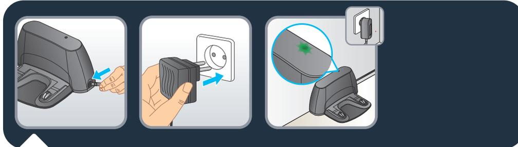
**RU** Подключите блок питания к разъему питания с боковой стороны зарядной станции. Используйте только входящее в комплект зарядное устройство: не пользуйтесь универсальными зарядными устройствами. Подключите вилку питания к розетке. После подключения шнура питания убедитесь, что на верхней стороне зарядной станции загорелся зеленый индикатор.
