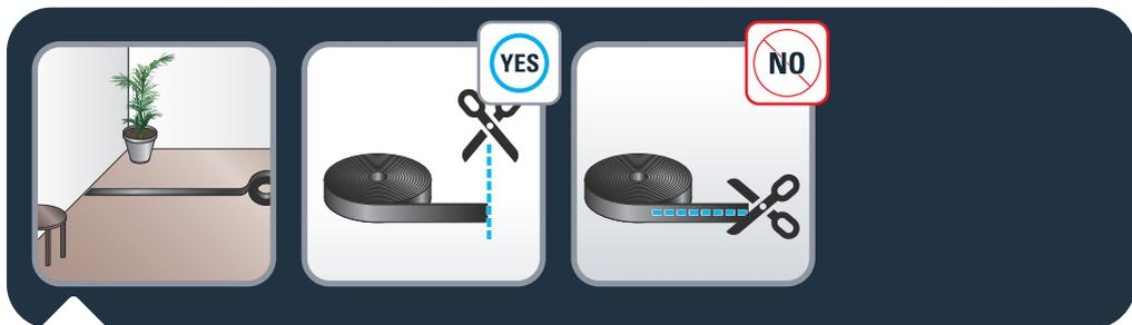
**RU** Используйте магнитную ленту для ограничения доступа робота в определенные зоны. Разместите магнитную ленту на полу для обозначения запретной для робота зоны. Магнитную ленту можно разрезать на куски необходимой для ограничения длины. Разрезать ленту следует только поперек.
