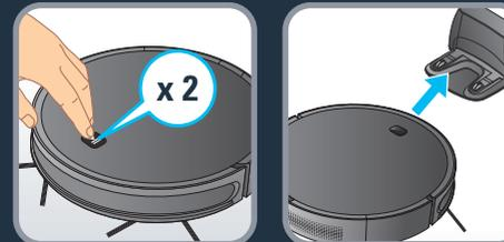
**RU** Для завершения сеанса уборки нажмите кнопку на корпусе робота. Для возврата робота на зарядную станцию, нажмите два раза на кнопку на корпусе робота.
