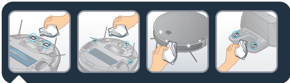
**RU** Очищайте следующие детали чистой сухой тканью один раз в неделю: контактные пластины робота, датчики падения, датчик расстояния, клеммы станции и переднее колесо робота.
