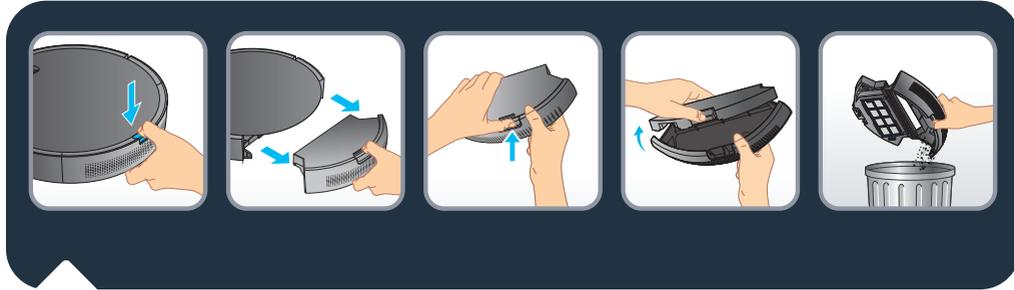
**RU** После каждого использования следует очищать контейнер для мусора. Для этого следует нажать кнопку на задней стороне робота и извлечь контейнер, после откинуть крышку, чтобы очистить его.
