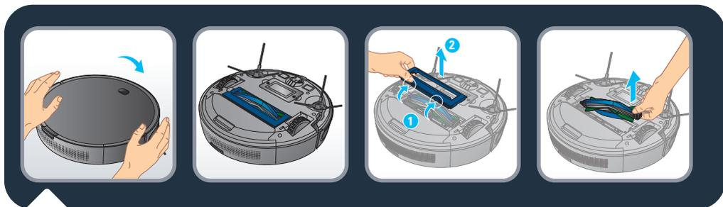
**RU** Очищайте щетку робота раз в неделю. Чтобы извлечь щетку, переверните робот, откройте защелки и выньте крышку щетки.
