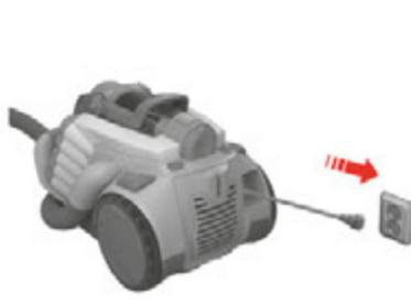
5. اسحب سلك الطاقة وقم بتوسيعه بمأخذ الكهرباء.
