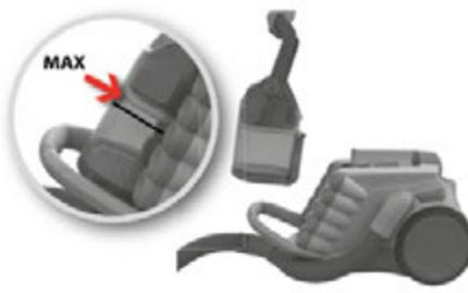
1. تفريغ الغبار: عندما يصل الغبار المضغوط إلى أقصى مستوى، ارفع حاوية الغبار من الجهاز عن طريق سحب مقبض الضاغط.
