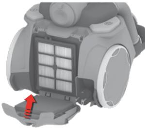
3. Αφήστε το να στεγνώσει για 24 ώρες πριν το τοποθετήσετε ξανά στη συσκευή. Το φίλτρο πρέπει να αντικαθίσταται κάθε 2 χρόνια.
