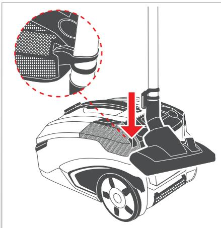
Для крепления всасывающей трубки на приборе использовать парковочное устройство, расположенное на телескопической трубе.
