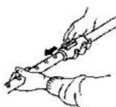
Регулировка телескопической трубы
