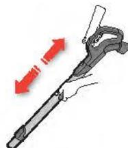
5. Регулируйте телескопичную тръба като с едната си ръка дръжките натиснат застопоряващия бутон и изтеглете дръжката с другата си ръка.
