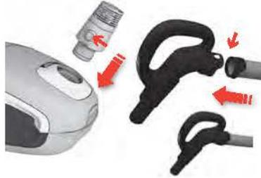
2. Įdėkite žarną (norėdami atjungti, paspauskite fiksavimo mygtuką ir ištraukite žarną). Įstatykite žarną į žarnos rankeną taip, kad spragtelėtų fiksuojantis (norėdami žarną nuimti, paspauskite fiksuojantį).
