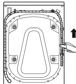
2. Подсоедините сливной шланг к канализации или закрепите его на краю раковины с помощью «U»-образного колена.
