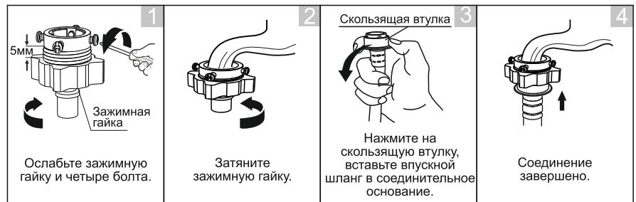
B. Соединение между винтовым краном и впускным шлангом.
