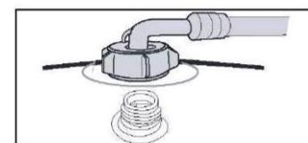
Примечания: после подсоединения, если в шланге есть протечка, повторите шаги, чтобы подсоединить заливной шланг. Для водоснабжения должен использоваться самый простой тип слива. Если слив квадратный или слишком большой, его нужно заменить стандартным.
