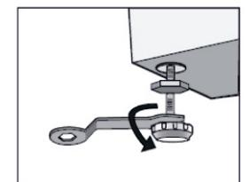
2. Установив стиральную машину, надавите по очереди на четыре угла на верхней крышке стиральной машины. Если стиральная машина при надавливании не устойчива, ножку на этом углу нужно выровнять.
