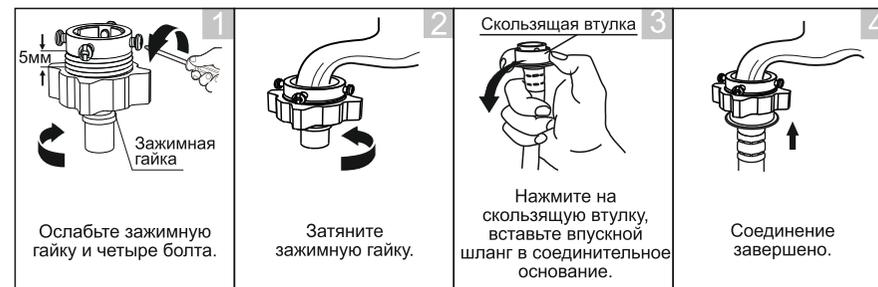
**В.** Соединение между винтовым краном и впускным шлангом.
