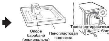
Снимите транспортировочные болты и опоры.
