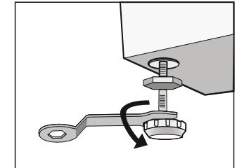
3. Проверьте положение стиральной машины. Ослабьте гаечным ключом зажимную гайку и поверните ножку рукой, пока она не будет плотно касаться пола. Надавите на ножку одной рукой и плотно прикрепите гайку к корпусу другой рукой.
