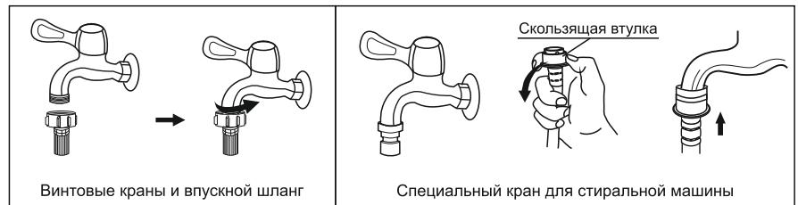
Подсоедините другой конец впускной трубы во впускной клапан сзади устройства и плотно закрепите трубу по часовой стрелке.
