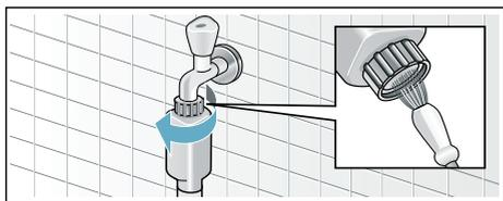
6. Чистка фильтра на задней стенке прибора:
