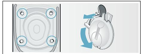
2. Вставить все 4 втулки. Зафиксировать сетевой кабель в креплениях. Вставить винты и затянуть их.
