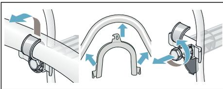
4. Извлечь сетевой кабель из креплений. Снять втулки.
