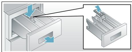
3. Ванночку для подачи моющих средств и вставку промыть в воде с помощью щетки и вытереть их насухо. Также выполнить чистку корпуса внутри.
