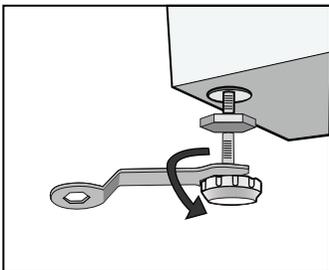
3. Проверьте положение стиральной машины. Ослабьте гаечным ключом зажимную гайку и поверните ножку рукой, пока она не будет плотно касаться пола. Надавите на ножку одной рукой и плотно прикрепите гайку к корпусу другой рукой.
