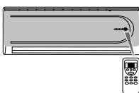
Нажатие на каждую кнопку ПДУ запускает процесс отсылки сигнала на внутреннее устройство кондиционера. В свою очередь, получив новую команду от ПДУ кондиционер посыпает сигнал обратно. При удачной отправке сигнала и получении подтверждения раздается звуковой сигнал, подтверждающий новую команду.
