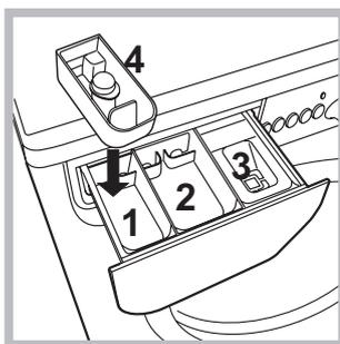
Эта функция служит для удаления наиболее трудных пятен. Вставьте прилагающийся дополнительный дозатор 4 в ячейку 1. Не заливайте отбеливатель в дозатор выше отметки «макс.» на центральной шкале (см. рисунок). Для осуществления только отбеливания
