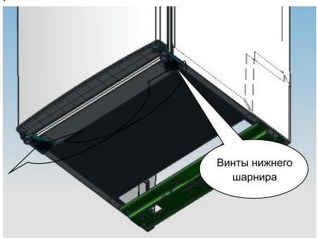
4. Переместите балансир на другую сторону и отрегулируйте его, чтобы обеспечить устойчивость корпуса.
